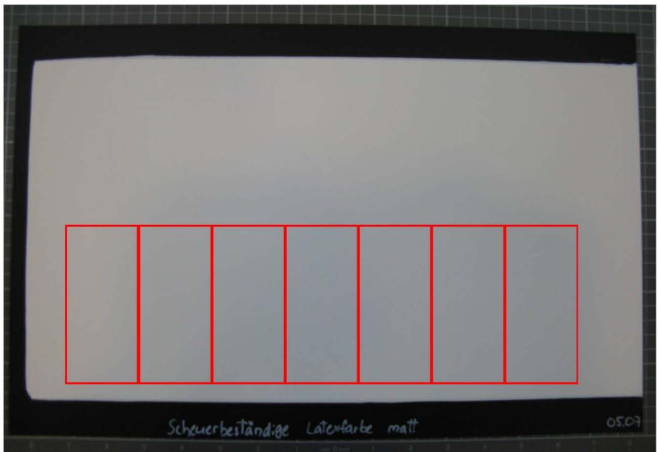
Abbildung 1: Exemplarisches Beispiel der zur Verfügung gestellten Proben (Prüfbereiche rot markiert)
