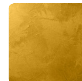
MultiStruktur fein, EffektGrund, 2x CapaGold șpacluit
